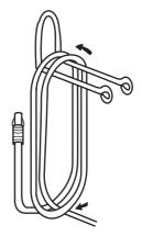
FIGURE A.13.6.4.6.2(b) Reverse Loop. [10:Figure A.7.6.2(b)
